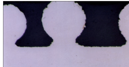
インビジブルオペーク塗布時の断面写真(×200)
