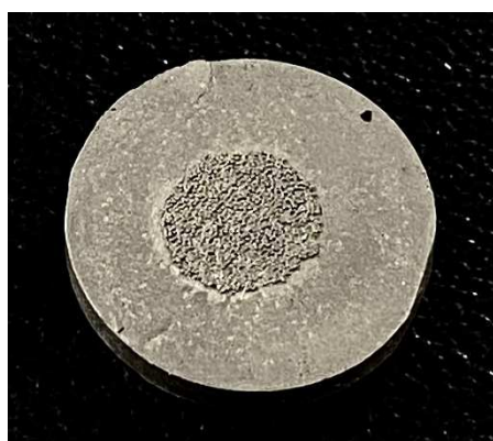
図 3-1 鋳造後の試験体 (チタン：リテンションビーズあり)
