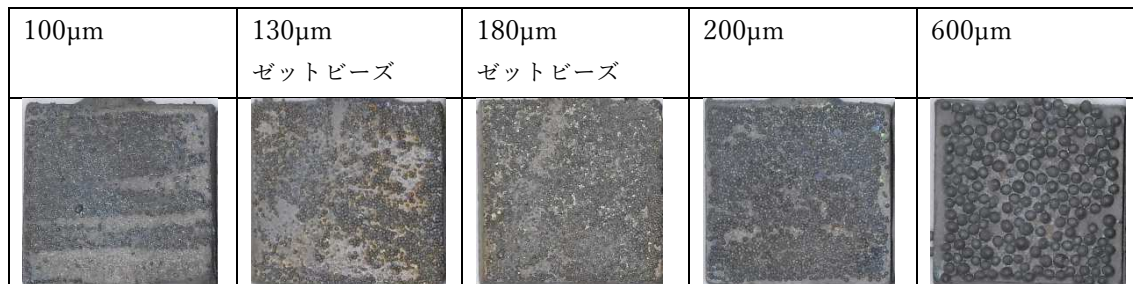
図 4-1 リテンションビーズ粒径の違いによるチタン鋳造体（純チタン 2 種）
