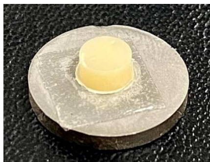
図 3-4 せん断接着試験片（左）および試験機に設置時の外観（右）
